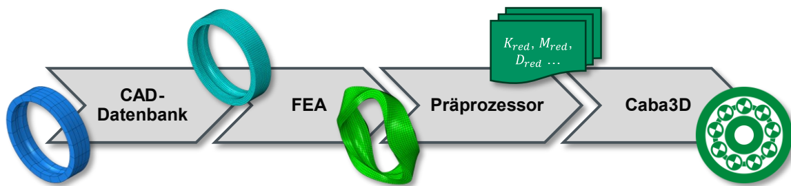
Abbildung 3: CAE-Prozess zur Integration der elastischen Lagerumgebung in Caba3D.
